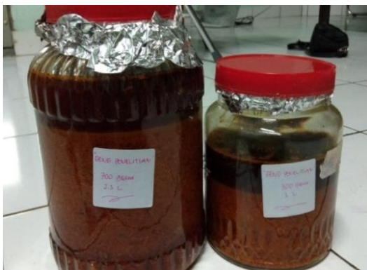
Gambar 5. Proses ekstraksi kayu secang secara maserasi
