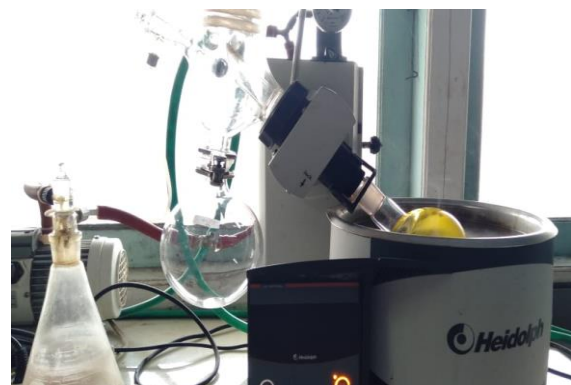
Gambar 6. Proses penguapan pelarut menggunakan alat Rotary evaporator
