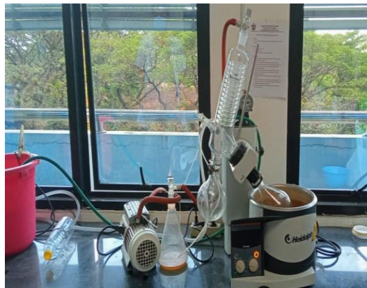
Gambar 7. Proses penguapan ekstrak cair dengan rotary vacum rotavapor
