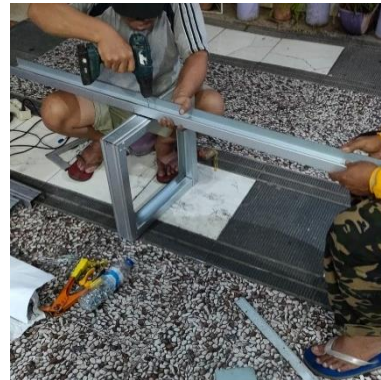
Gambar Lampiran 4. Pembuatan Rangka Lampu Perangkap
