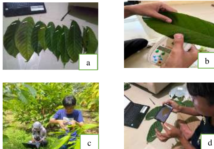
Gambar Lampiran 5. a. Sampel daun tanaman kakao b. Pengamatan klorofil daun menggunakan Content Chlorofil Meter (CCM 200 + ) c. Pengamatan komponen energi cahaya matahari menggunakan Miniature Leaf Spectrometer d. Pengamatan luas daun menggunakan aplikasi Petiole Leaf Area Meter
