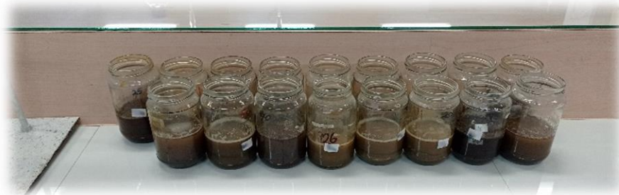
Pengukuran tekstur tanah menggunakan metode hydrometer di laboratorium
