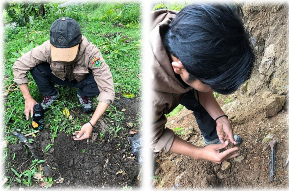
Pengamatan tekstur tanah di lapangan dengan metode feeling
