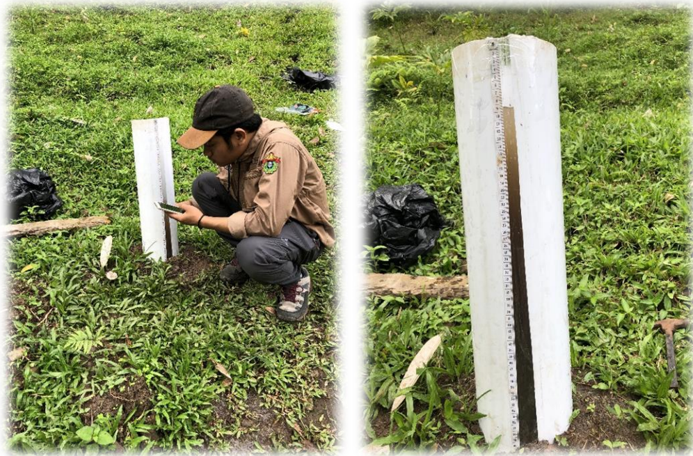
Pengamatan laju infiltrasi di lokasi longsor I ( \pm 10 meter dari titik longsor)
