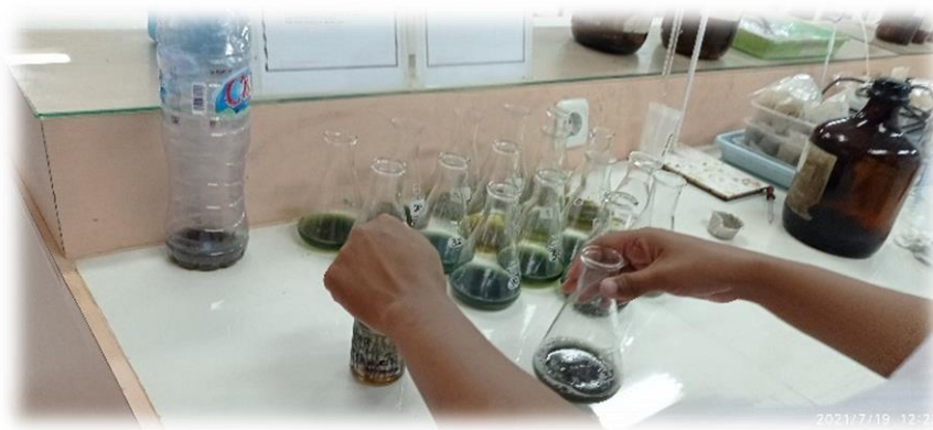
Pengukuran tekstur tanah menggunakan metode hydrometer di laboratorium
