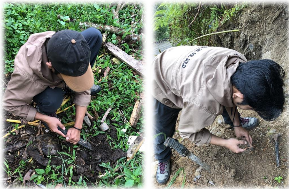
Pengambilan sampel tanah utuh dan sampel tanah terganggu
