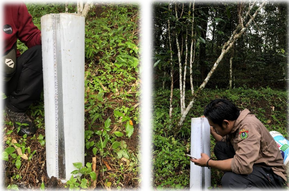
Pengamatan laju infiltrasi di lokasi longsor II ( \pm 50 meter dari titik longsor)
