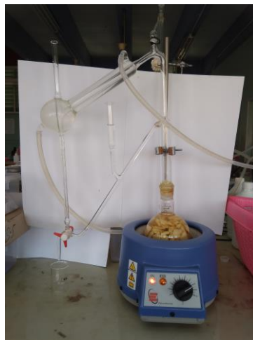
Gambar 107. Penyulingan Minyak Atsiri menggunakan alat Stahl
