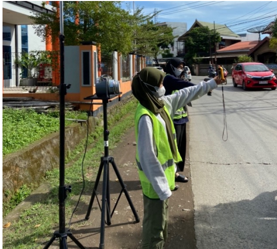
Gambar 5. Pengambilan Sampel TSP Di Jalan Tamangapa Raya
