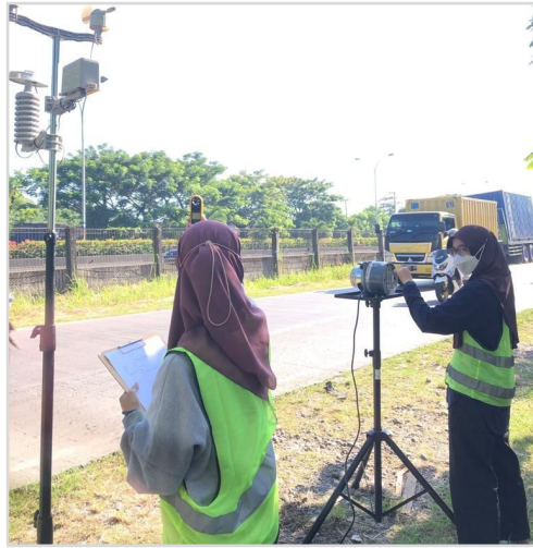
Gambar 1. Pengambilan Sampel TSP Di Jalan Ir. Sutami
