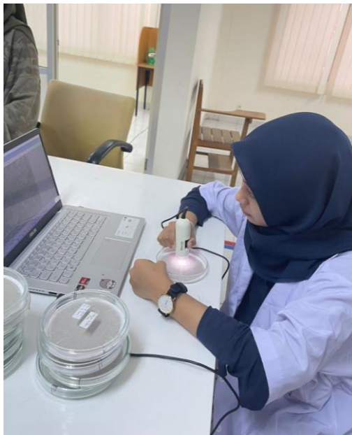
Mengidentifikasi Mikroplastik menggunakan Mikroskop Dino-Lite
