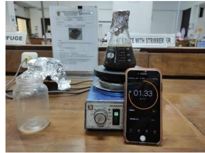
Pengadukan sampel yang telah dicampurkan NaCl 30% selama 2 menit
