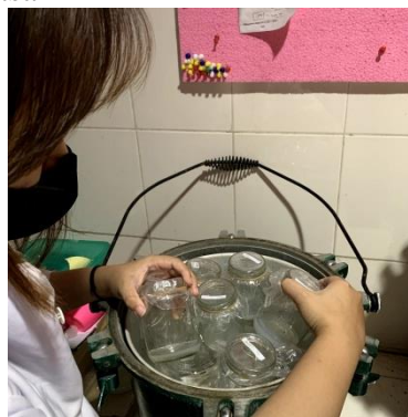
7. Sterilisasi Media Menggunakan Autoclave
