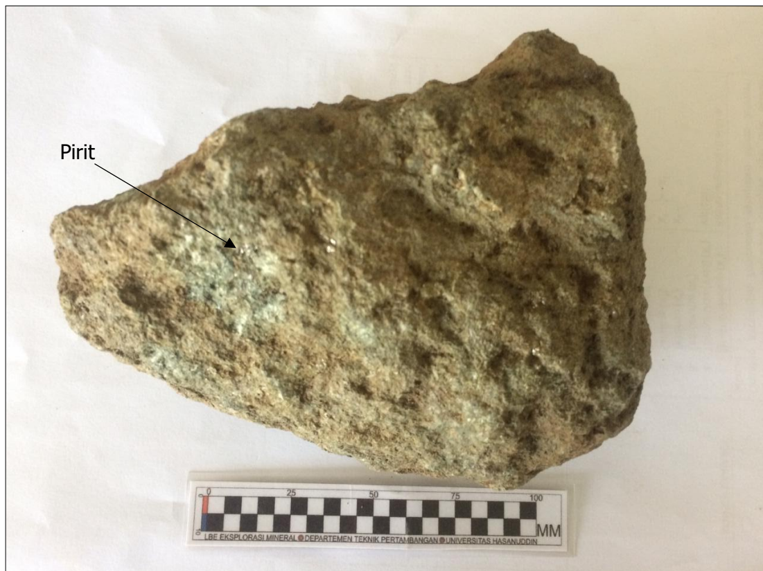
Gambar.3 Sampel hand specimen Diorit, terdapat mineral sulfida berupa pirit ( disseminated ) yang diambil dari Singkapan di Stasiun 3.
