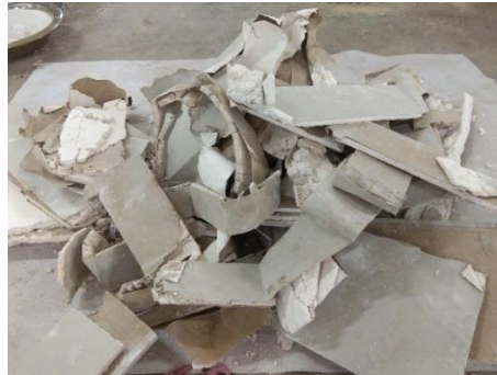
Gambar 2. 2 Limbah Gypsum Board dari Sisa Konstruksi Bangunan
