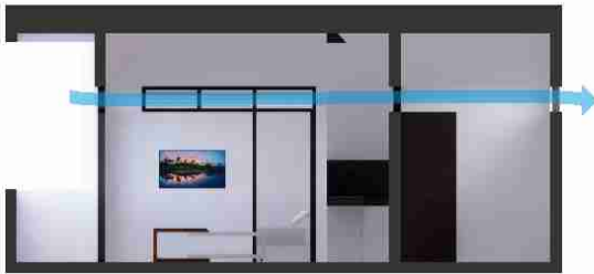
ILUSTRASI CROSS VENTILATION PADA UNIT HUNIAN
