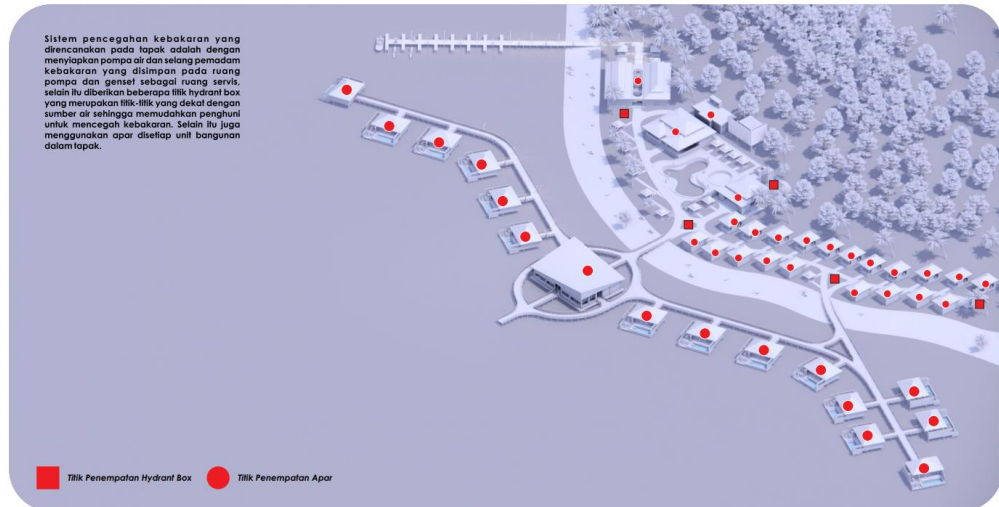
Gambar 16 Sistem Pencegahan Kebakaran
