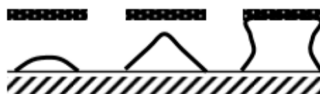
Gambar 10. Pembentukan Tombolo pada pantai yang dipasang Breakwater
