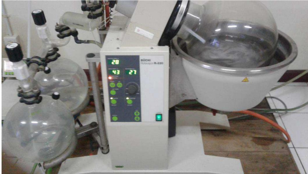
Gambar 02. Evaporator vakum
