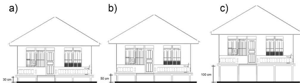
Gambar 6 Tinggi Rumah Panggung Bulungan Sumber : Analisa Survei Lapangan, 2021
