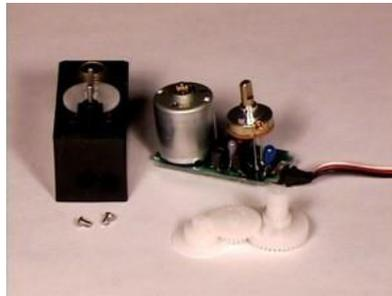
**Gambar 2. 6** Bentuk Fisik Servo Motor
