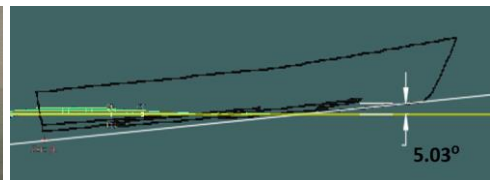
Kondisi Trim 5.03 derajat model kapal deadrise angle 10 Derajat dengan 3 Stepped 2U dengan kecepatan 3.846 m/s
