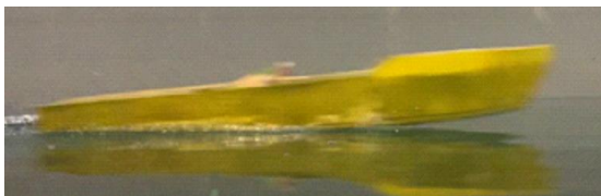
Kondisi Trim 5.03 derajat model kapal deadrise angle 10 Derajat dengan 3 Stepped 2U dengan kecepatan 3.846 m/s
