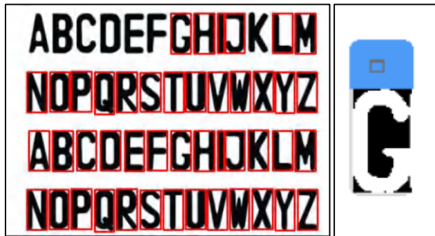
Gambar 3.10 Hasil Segmentasi Karakter (a) ROI setiap karakter, (b) ROI yang telah dicrop
