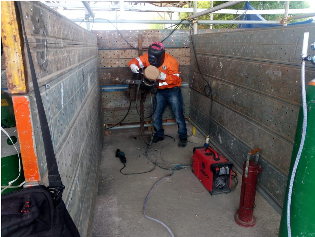
Proses pengelasan kombinasi SMAW-GTAW posisi 6G
