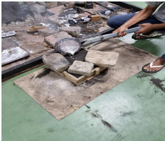
Proses penuangan aluminium cair pada cetakan
