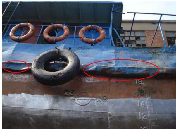
**Gambar 2.8** *fender* yang mengalami benturan pada kapal (Zhiyu jiang dan Mintong Gu, 2010)
