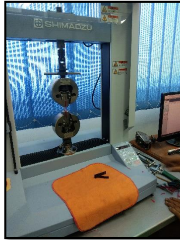
Gambar B.2 Uji Tensile/Tarik
