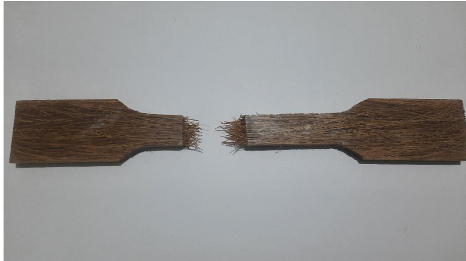
Gambar Spesimen Serat arah 0° Setelah Uji Tarik
