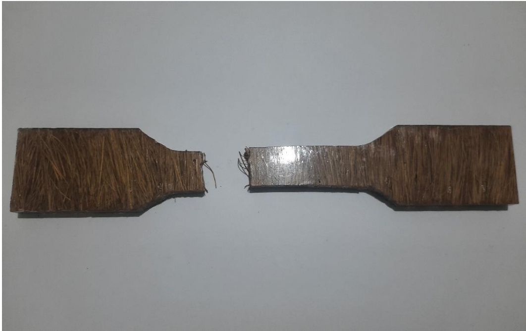
Gambar Spesimen Serat Arah 90° Setelah Uji Tarik
