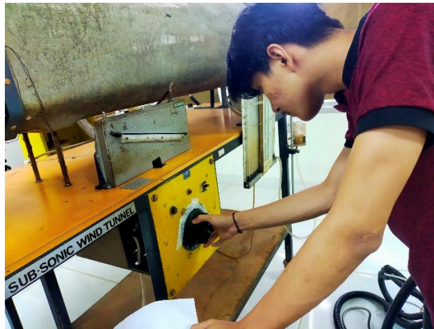
Proses setting kecepatan blowing
