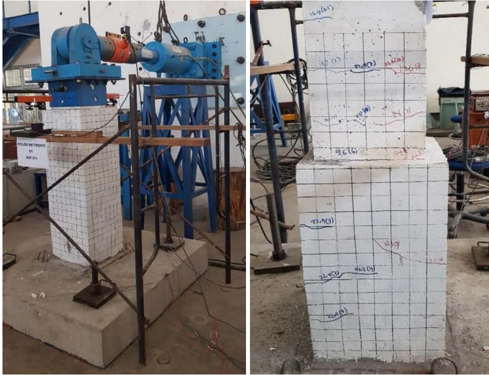
Pengujian dan Pola Retak Benda Uji
