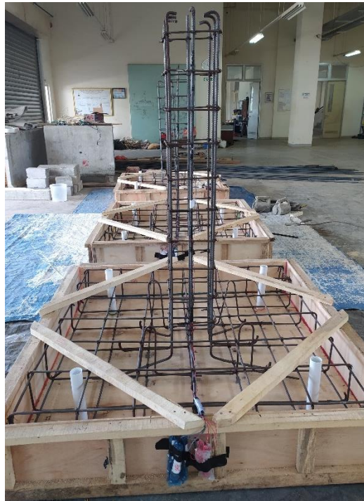
Pemasangan Strain Gauge Baja
