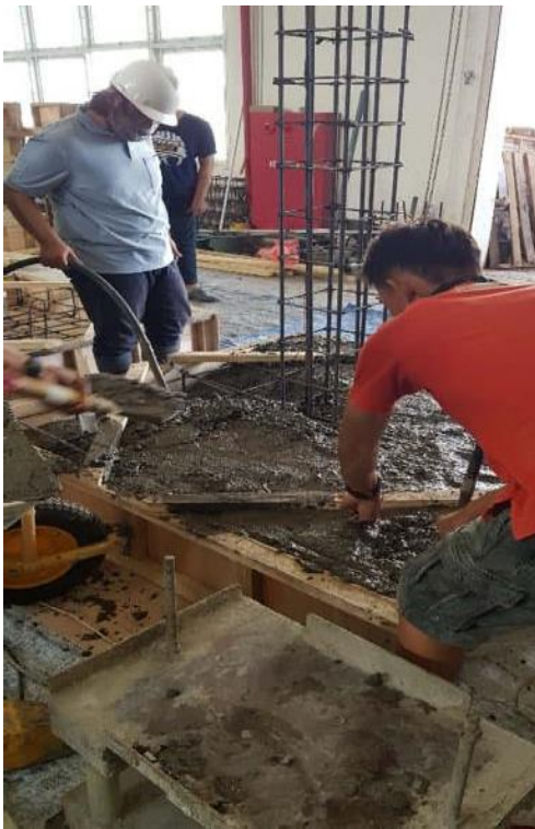
Proses Pengecoran Benda Uji
