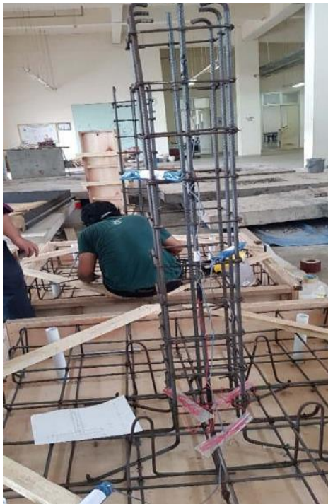
Pemasangan Strain Gauge Baja
