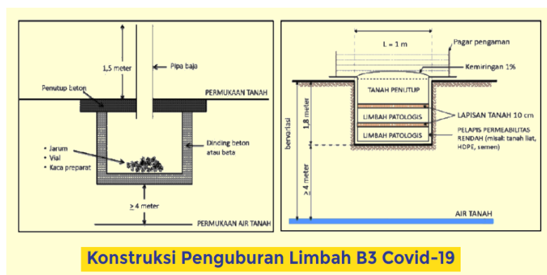
Gambar 9. Konstruksi Penguburan Limbah B3 Covid-19
