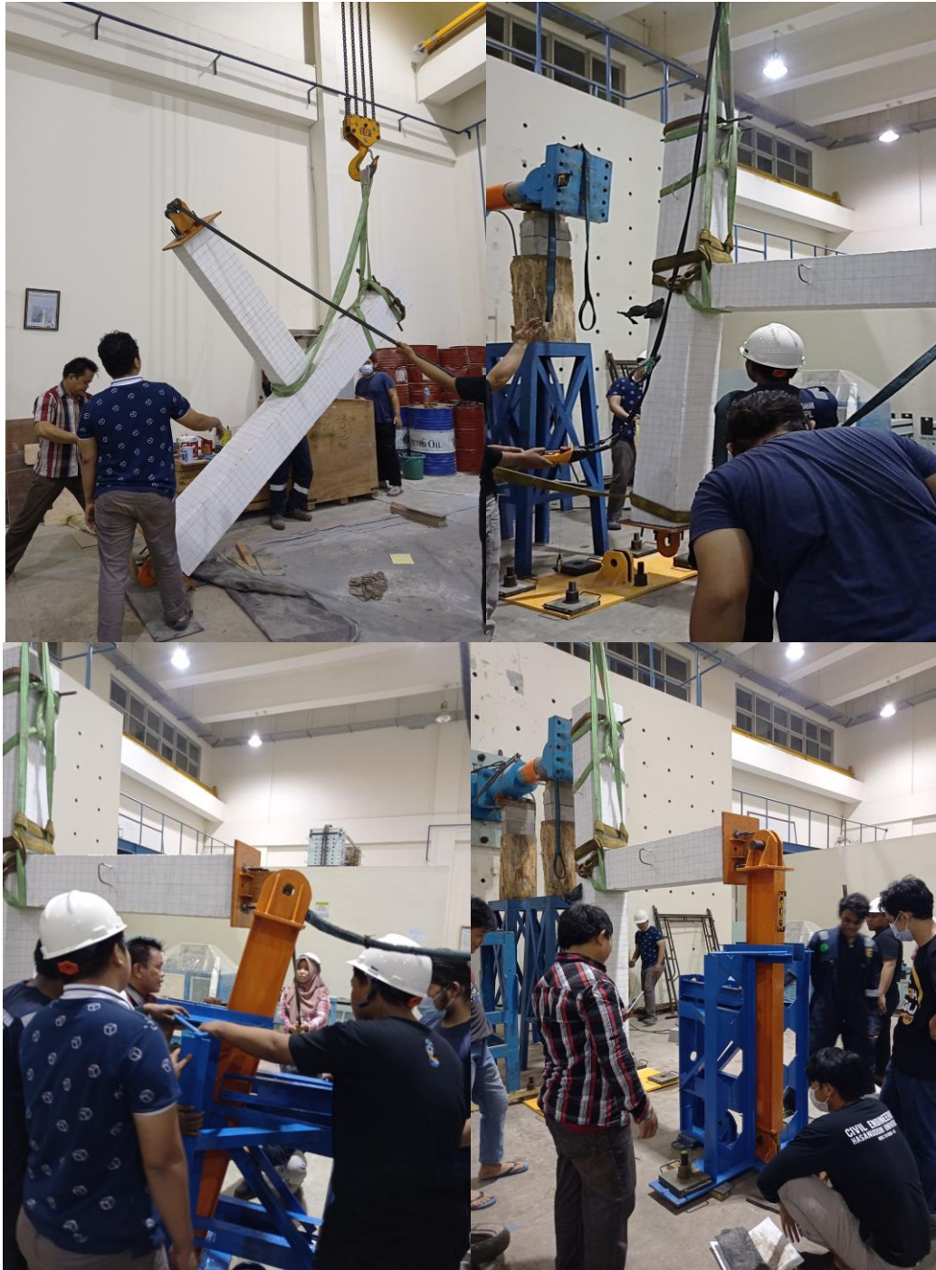
Setting Alat dan Benda Uji Sambungan Balok Kolom
