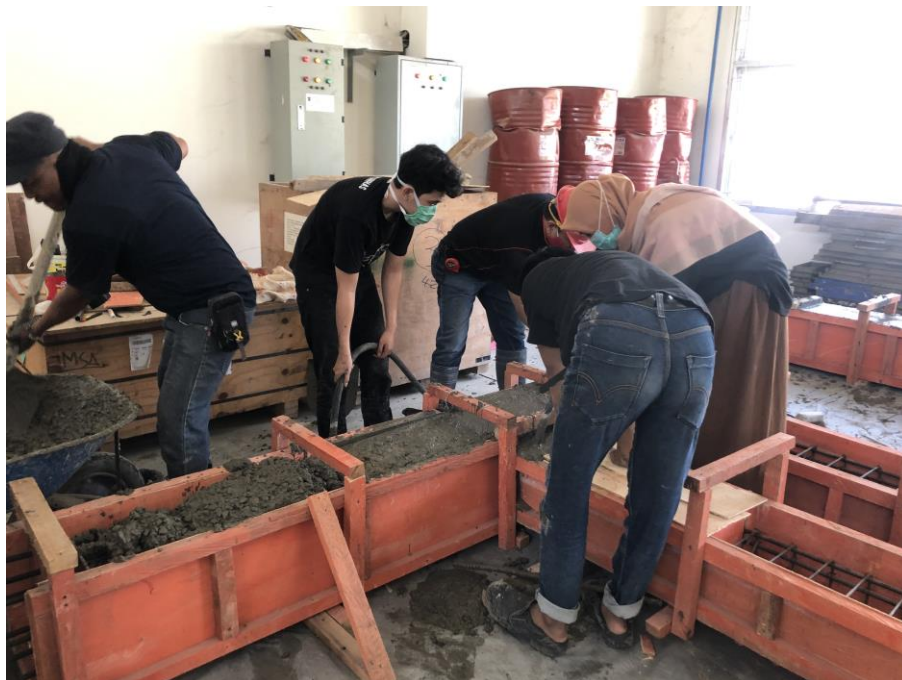
Pengecoran Benda Uji SBK Pracetak 2 Pasak (BG-01)
