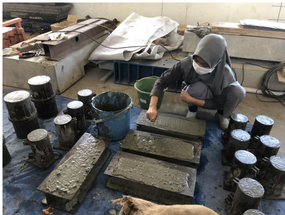
Pengecoran Benda Uji Karakteristik Beton Normal
