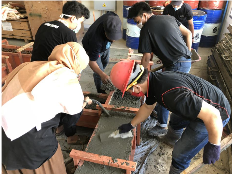
Pengecoran Benda Uji SBK Beton Monolit (BN)
