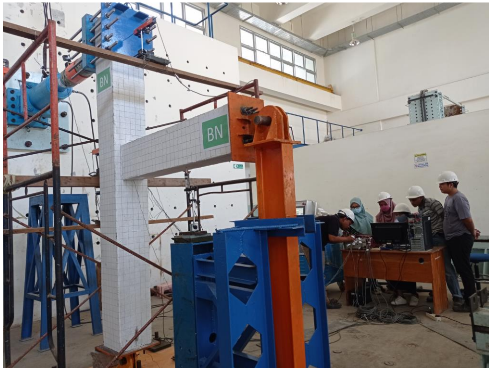
Pengujian Benda Uji SBK Beton Monolit (BN)
