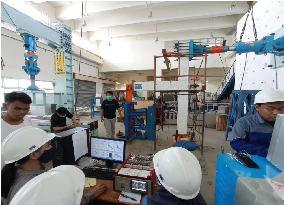
Pengujian Benda Uji SBK Pracetak 4 Pasak (BG-02)
