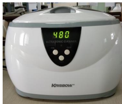
Gambar 32. Ultrasonikasi sampel sebelum dianalisis menggunakan spektrofotometer UV-Vis
