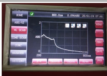
Gambar 35. Hasil spektrum pada layar spektrofotometer-UV Vis
