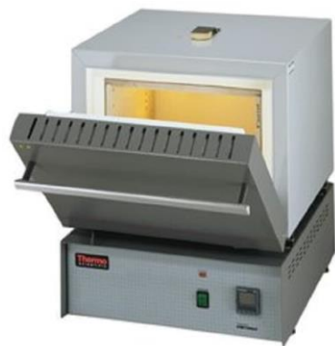
29. Kalsinasi menggunakan tanur suhu 200°C selama 5 jam
