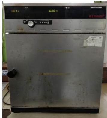
Gambar 27. Pengeringan menggunakan oven suhu 100°C selama 8 jam
