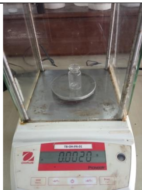
Gambar 31. Penimbangan nanopartikel ZnO untuk pengukuran absorbansi di minggu ke 2 dan ke 3
