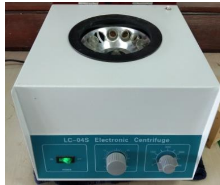
Gambar 26. Sentrifugasi kecepatan 3000 rpm selama 10 menit
