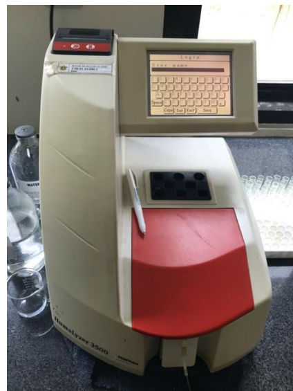
Gambar 17. Humalyzer 3500 (pengukuran sampel plasma)
