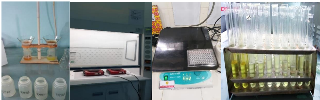
Destruksi basah dan di panaskan hingga larutan kuning jernih
