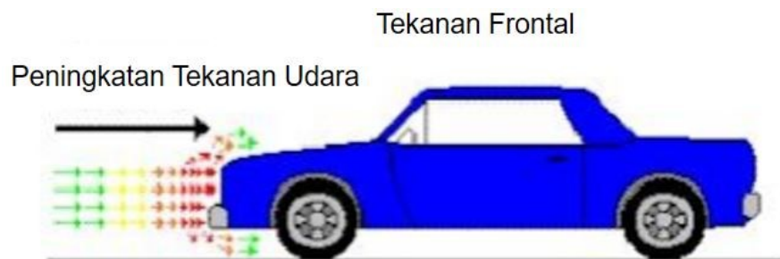
Gambar 2.6. Tekanan Frontal Pada Mobil (Azizi, 2010)
