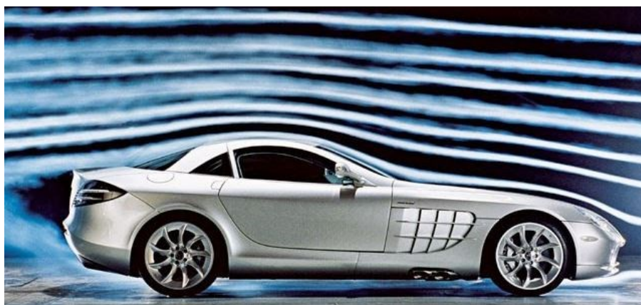
Gambar 2.1. Aliran Udara di Sekitar Kendaraan (Azizi, 2010)
