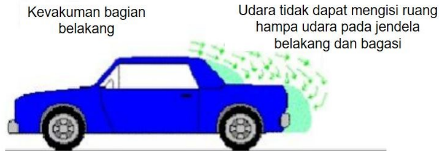
Gambar 2.7. Rear Vacuum Daerah Belakang Mobil (Azizi, 2010)
