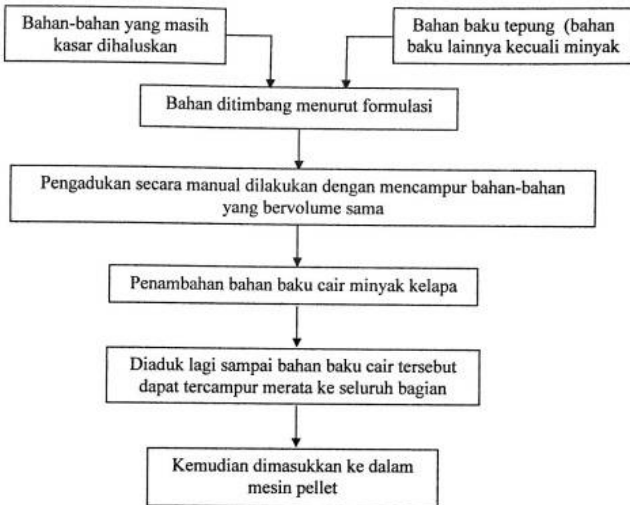
Gambar 3. Diagram Proses Pembuatan Pakan Bentuk Pellet
