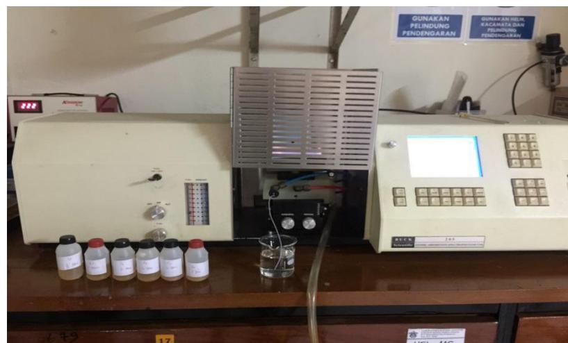
Gambar 20. Proses Pengukuran Absorbansi dengan Spektrofotometer Serapan Atom
