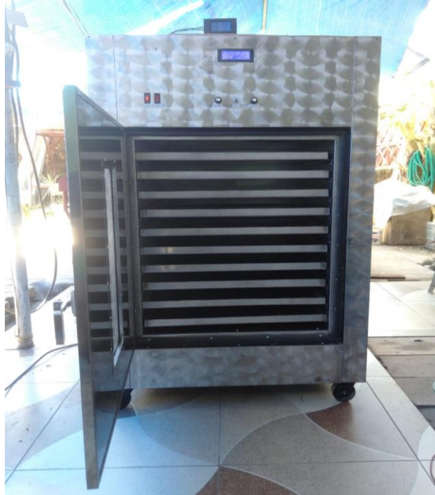
Gambar 1. Mesin pengering hybrid sistem
