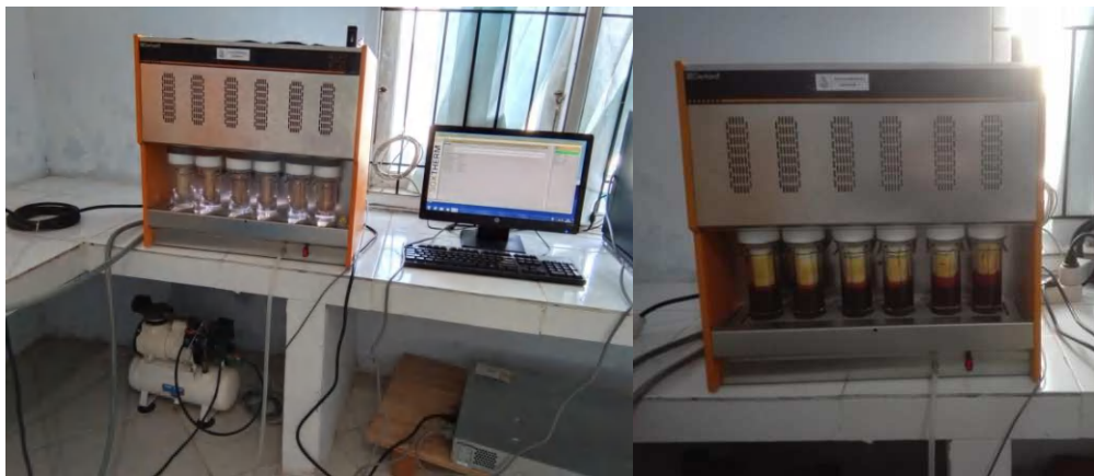
Gambar 9. Proses Ekstraksi betakaroten dari wortel menggunakan alat Soxtherm.
