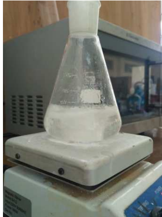
L.4. Proses melarutkan \text{SnCl}_2 dengan etanol sebagai larutan yang digunakan sebagai lapisan kaca agar menjadi kaca konduktif.
