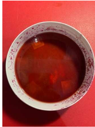
Gambar 4.6. Perendaman kaca yang telah dilapisi \text{TiO}_2 pada dye buah Buni.
