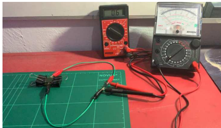
L.19. Pengukuran Voc (Tegangan Open Circuit ) pada DSSC yang telah dirakit.
