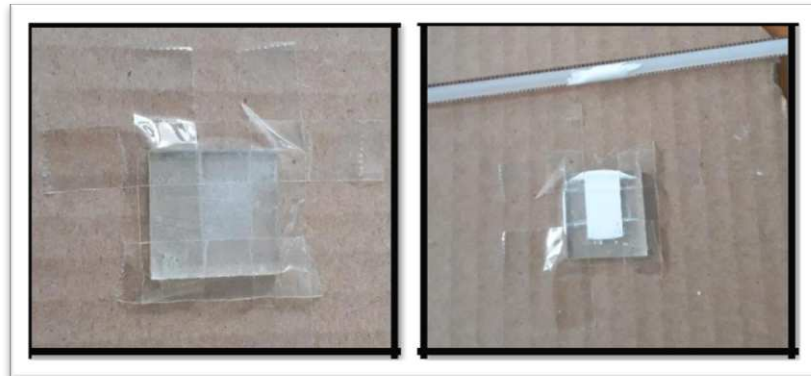
L.15. Proses pelapisan kaca konduktif dengan pasta TiO 2 dengan menggunakan metode doctor blade .
