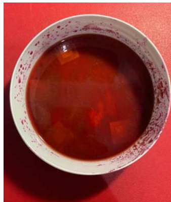
L.16. Proses perendama kaca konduktif yang telah dilapisi pasta TiO 2 dengan variasi lama waktu yang telah ditentukan.
