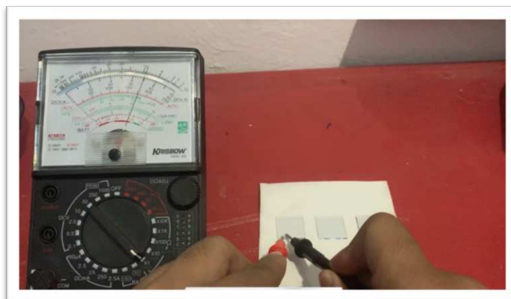
6. Pengukuran resistansi pada kaca konduktif setelah melalui proses penyemprotan larutan \text{SnCl}_2 dan pemanasan 500^\circ\text{C} selama 10 menit.
