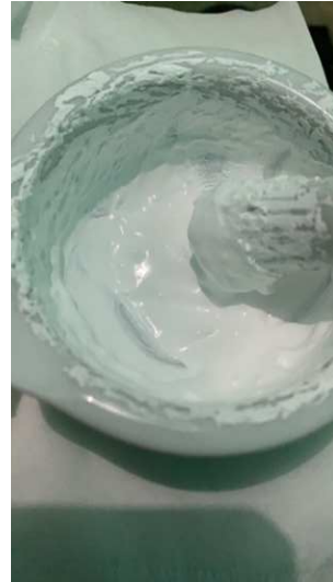
L.7. Proses pembuatan pasta \text{TiO}_2 dengan mencampurkan 1 gr HEC + 25 ml etanol dan 6 gr \text{TiO}_2 + 9 ml asam asetat.
