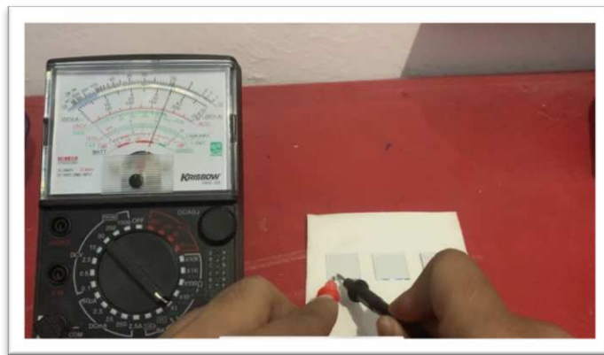
Gambar 4.2. Pengukuran nilai resistansi pada kaca konduktif yang telah di sintering .
