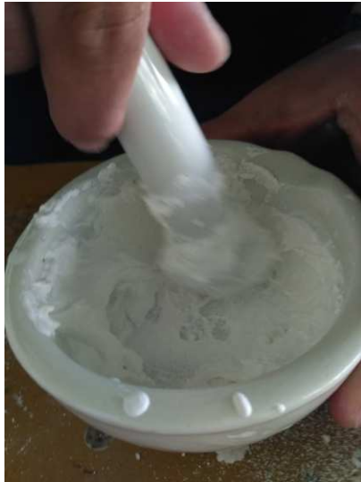
L.7. Proses pembuatan pasta \text{TiO}_2 dengan mencampurkan 1 gr HEC + 25 ml etanol dan 6 gr \text{TiO}_2 + 9 ml asam asetat.
