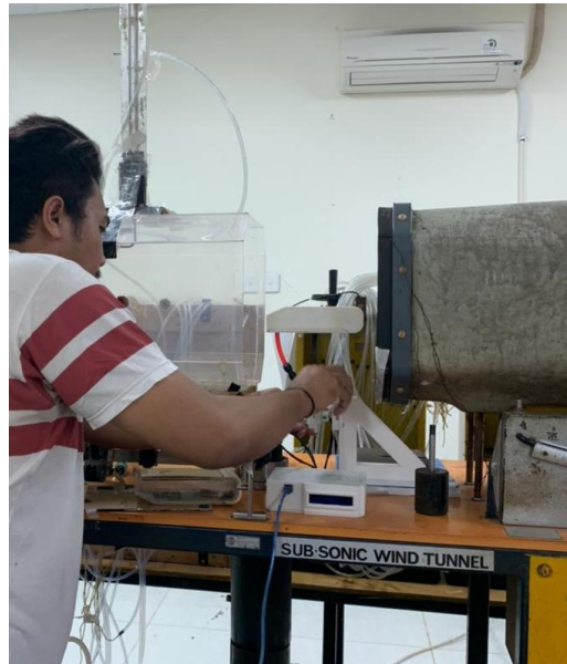
Dok. 1 Pemasangan model kedalam Wind Tunel
