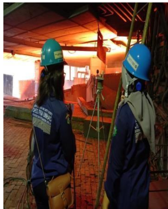
Gambar 5. Pengukuran Iklim Kerja di tapping deck
