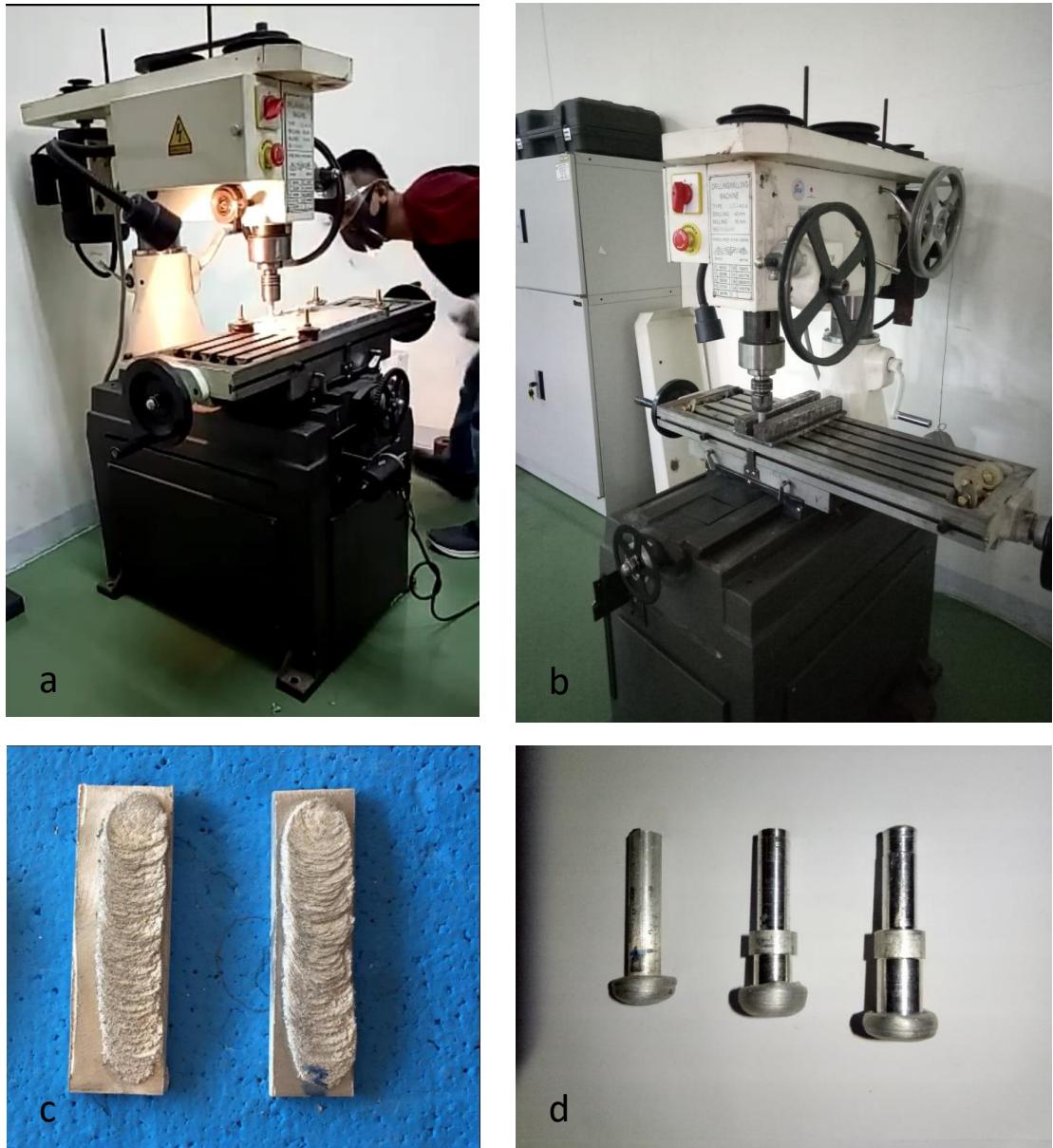
Gambar B.1 Proses friction surfacing (a) Pembuatan spesimen (b) Mesin drilling-milling LC-40A (c) Hasil FS (d) rod setelah FS
