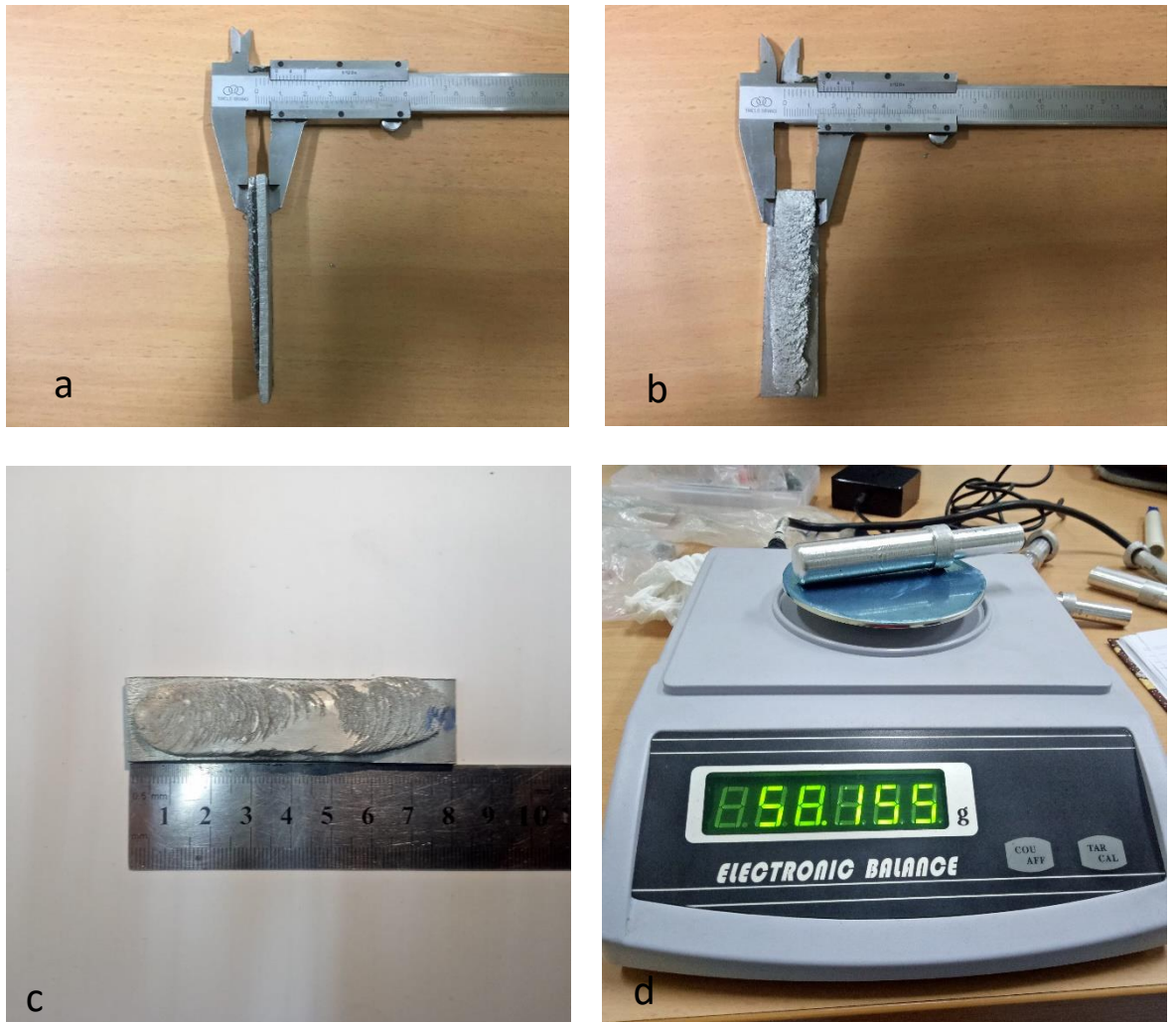
Gambar B.2 Pengukuran dimensi dan massa rod (a) Tebal (b) Lebar (c) Panjang (d) Massa rod
