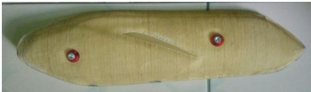
Gambar 2. 2. Hasil produk cover knalpot dengan penguat serat rami (Wisnujati dkk 2018)
