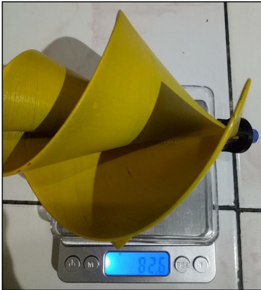
Gambar sudu Archimedes spiral kemiringan 45°
