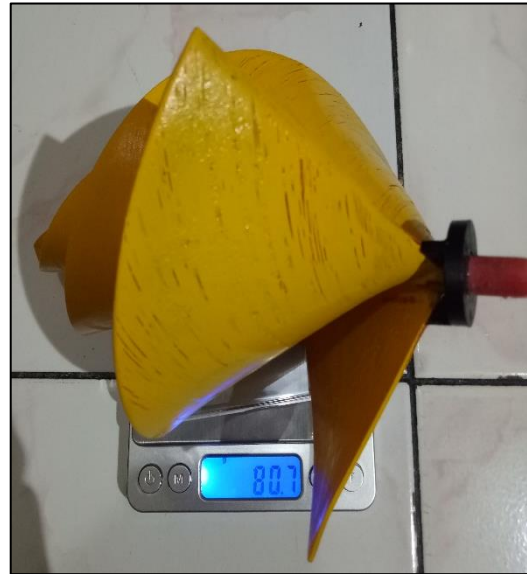
Gambar sudu Archimedes spiral kemiringan 60°
