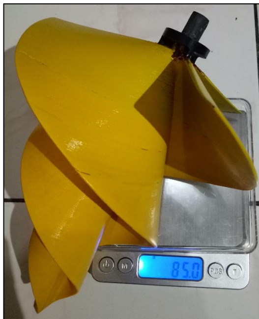
Gambar sudu Archimedes spiral kemiringan 75°
