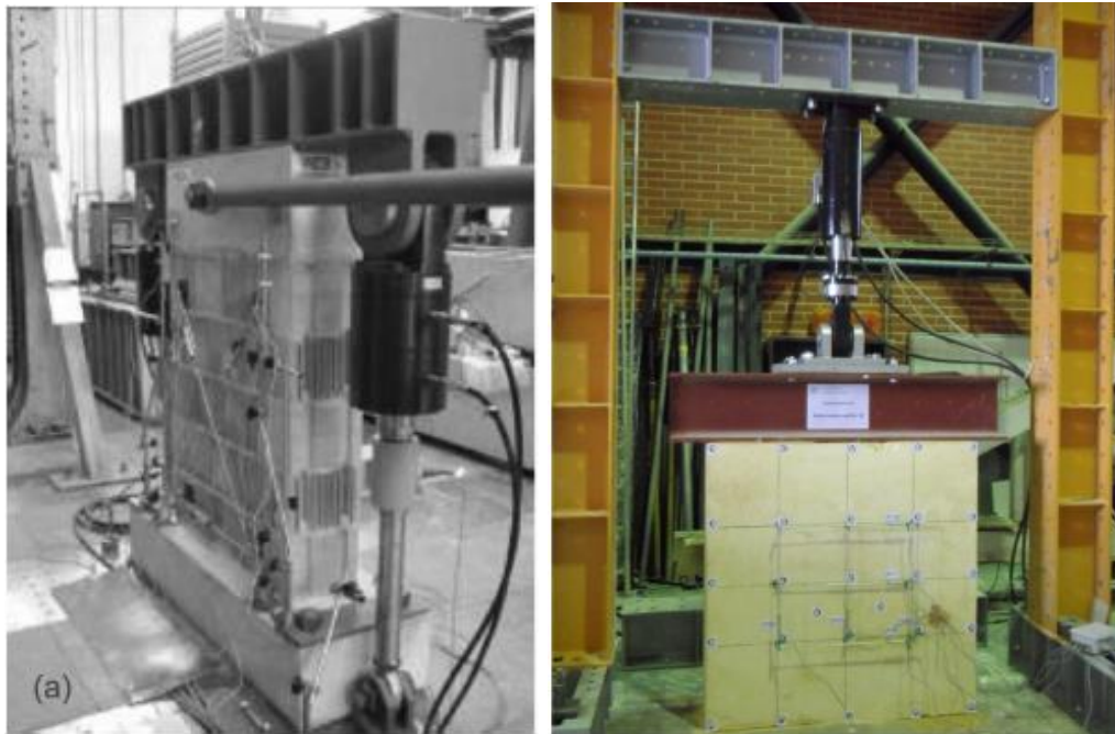
Gambar 12. Pengujian geser siklik dinding geser batu bata ( masonry )
