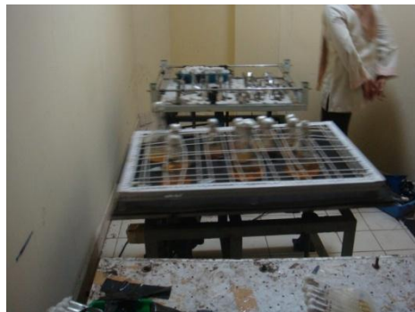
Gambar 3.5 Proses Pengocokan ( shaking ) Campuran Bakteri dengan Media B4
