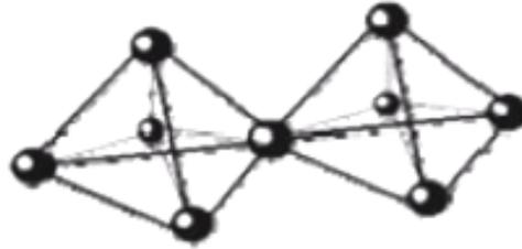
*Gambar 1. Tetrahedral alumina dan silika pada struktur zeolit (Las, 2004)*
