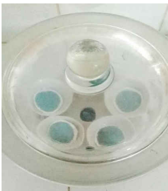
Hasil pemanasan kertas saring menggunakan oven
