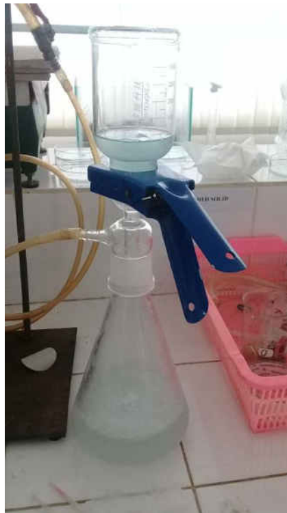
Penyaringan kertas saring menggunakan pompa vakum
