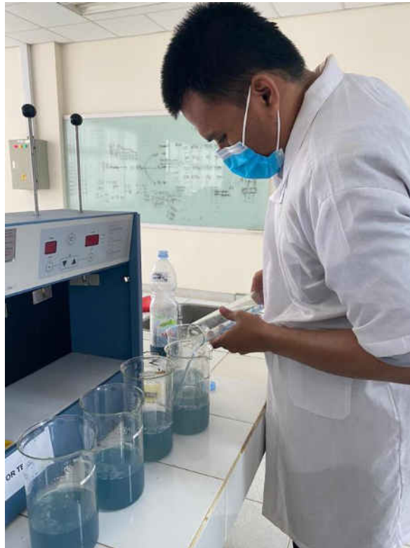
Persiapan larutan sebelum pengadukan dengan flocculator
