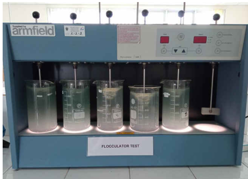
Proses pengadukan dengan flocculator
