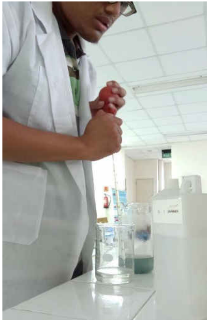
Pencampuran sampel limbah dengan bahan kimia (larutan penyangga)
