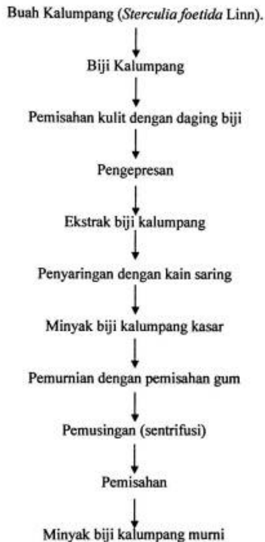
Gambar 3. Bagan Alir Pembuatan Minyak Kalumpang (Prihandana dkk., 2006).
