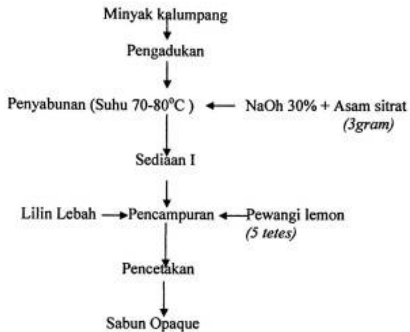
Gambar 4. Bagan Alir Pembuatan Sabun Opaque (Prihandana dkk., 2006.)
