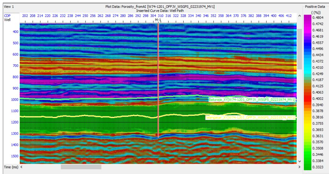
2. Penampang porositas hasil transformasi impedansi akustik pada sumur PU-1
