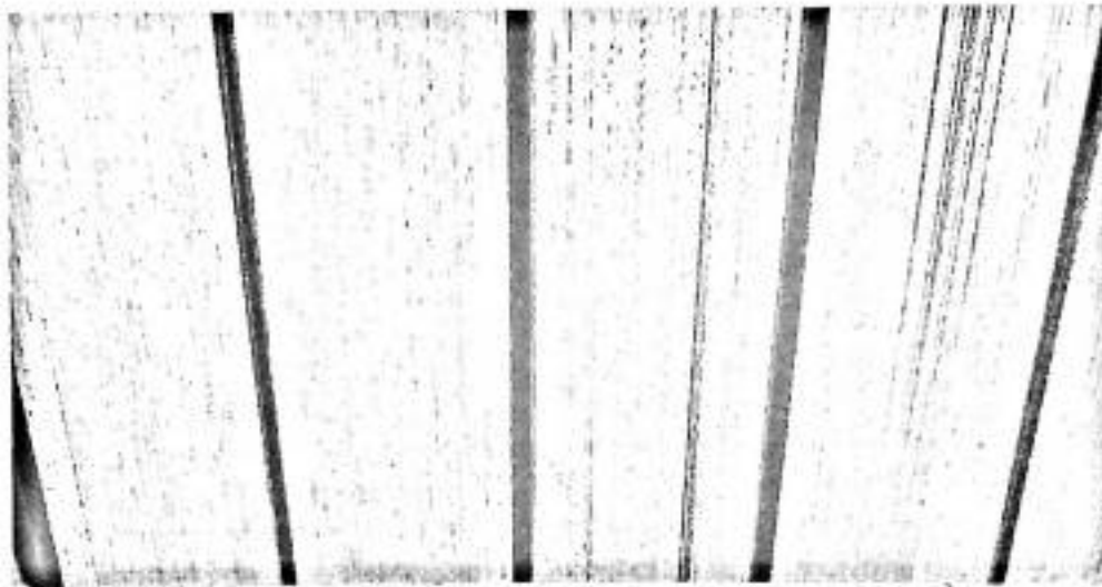
Gambar 1. B : Hasil pengujian Seriplane Benang Sutera Desa Solie
